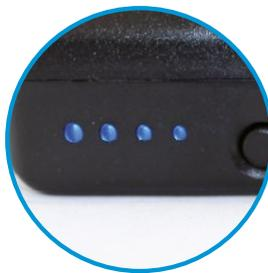
LED Kapazitätsanzeige die auf Knopfdruck die Kapazität anzeigen.
